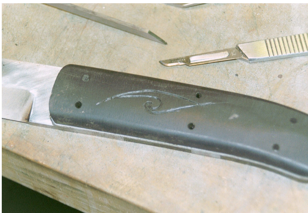
Afb.63: Het snijden van de gleuf
