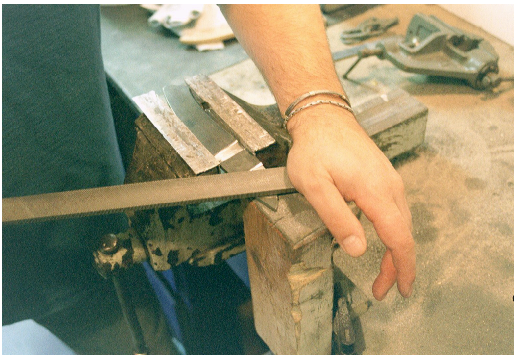
Afb.16: Stap 3 tanden vlakken met blokvijl
