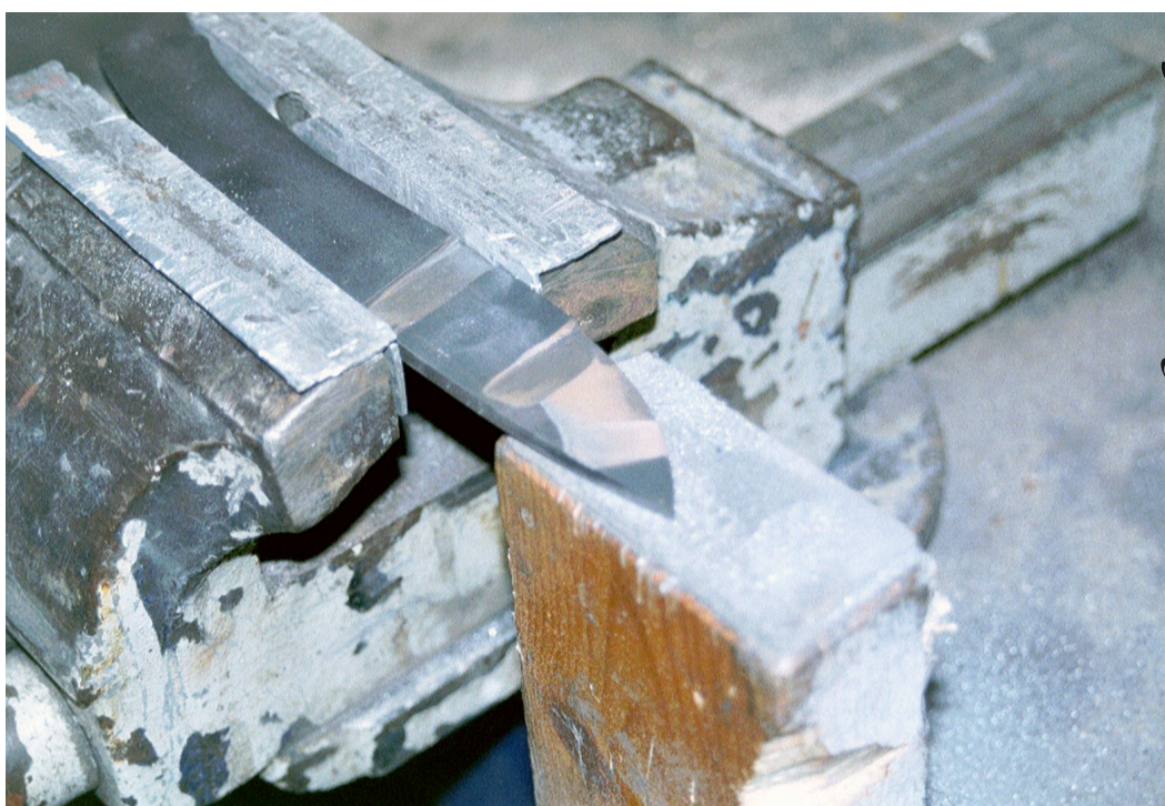
Afb.17: Stap 3 resultaat "tanden" vlakken met blokvijl
