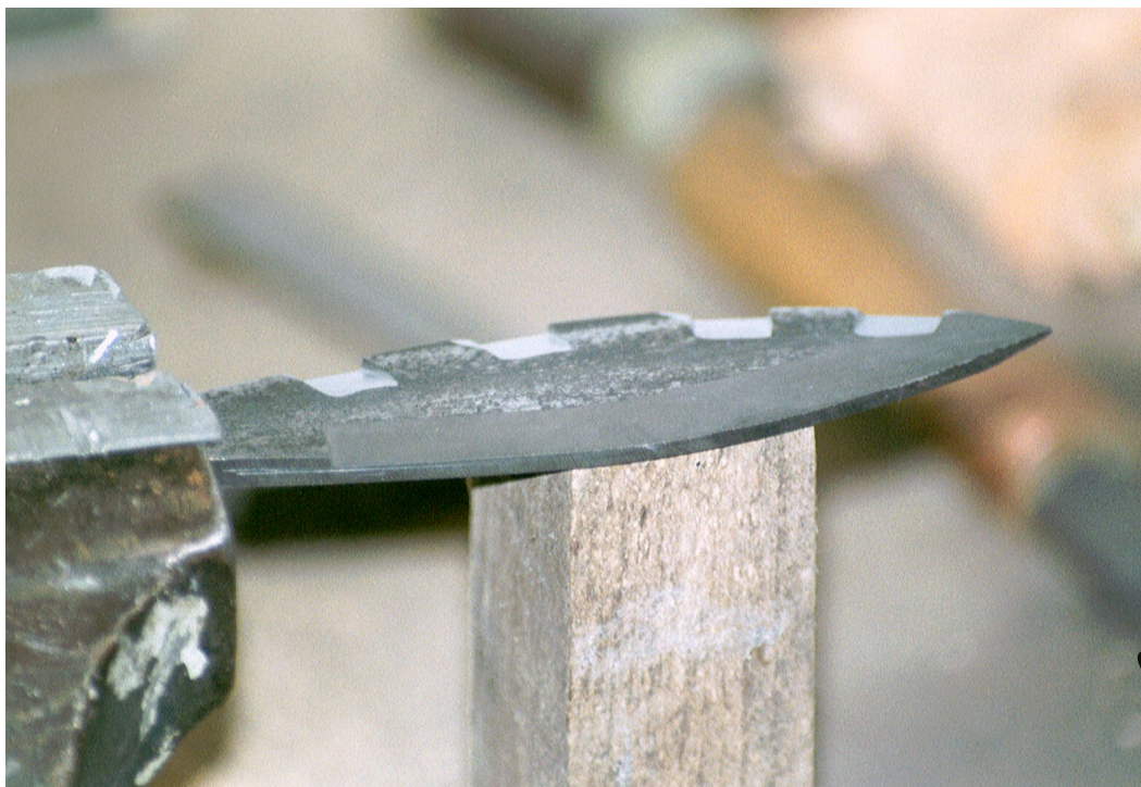
Afb.59: Klaar met vijlen met de vierkante vijl
