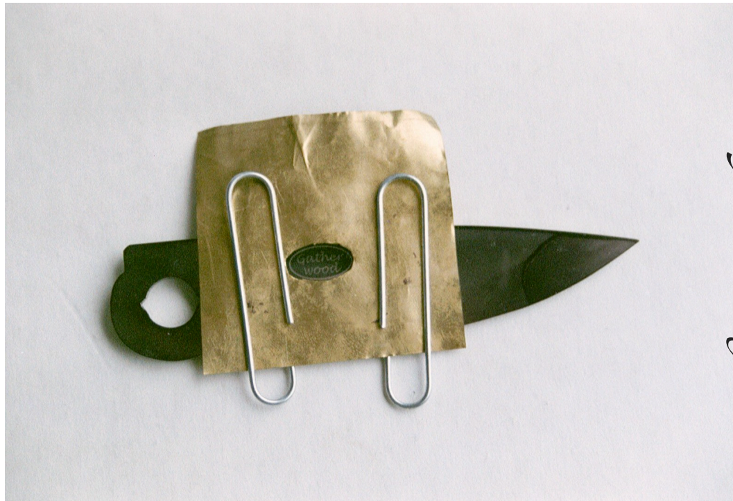
Afb.35: Negatief op mes + rest afgedekt tegen belichting.
