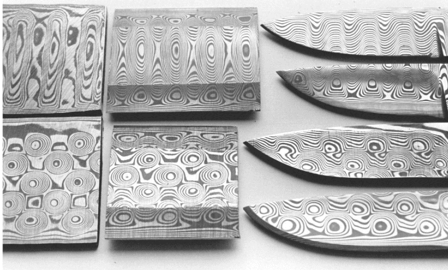
Afb. 72: Effecten van bewerkingen. (bron : Dama steel) Soms loont het de moeite je mes iets schuin uit het staal te halen voor een fraaier patroon
