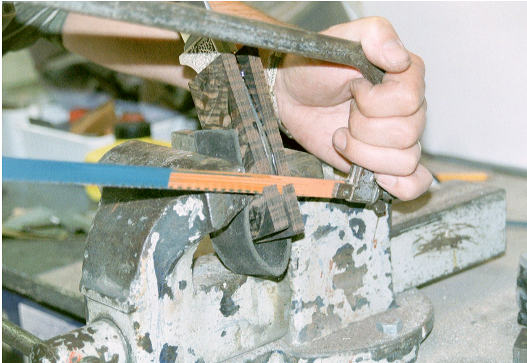
Afb.55 : Grote stukken handvat verwijderen met de ijzer zaag.
