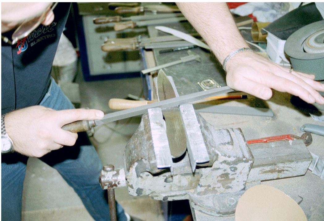
Afb.12: Stap 1 vijlen met vierkante vijl
