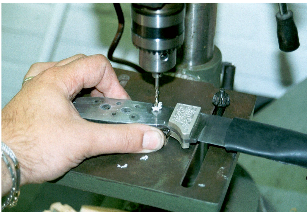
Afb.53: Gaatjes in het heft, gebruik blad als mal voor hout eronder.
