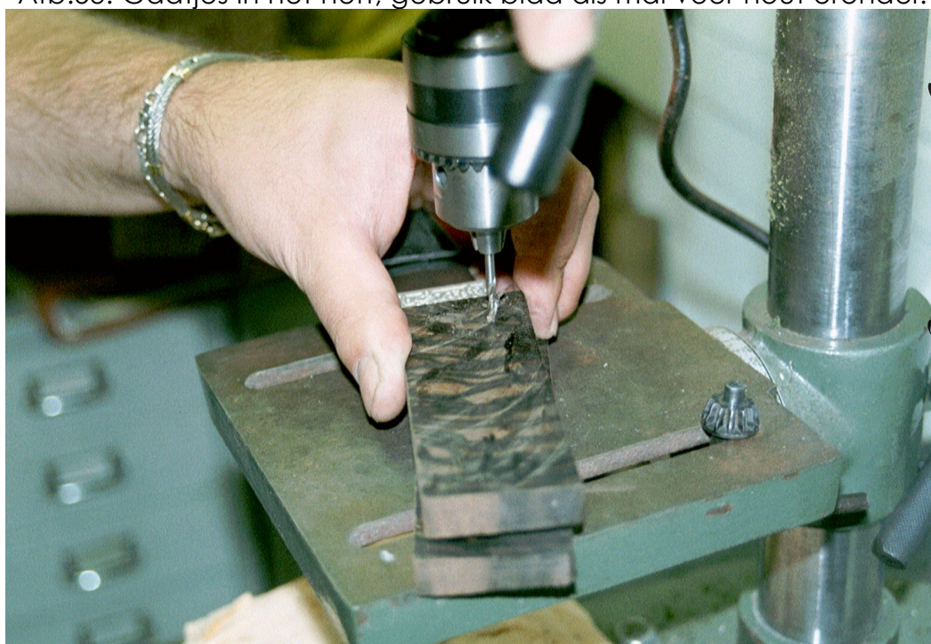
Afb.53: Gaatjes in het heft, gebruik blad als mal voor hout eronder.
